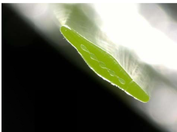
La géométrie de la fibre en coupe: son âme comporte cinq fins noyaux de polyamide enveloppés dans une gaine de polyéthylène.
