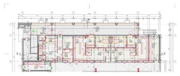
Au 1<sup>er</sup> étage, par rapport à la situation actuelle, le projet prévoit également la création d'un vestiaire PMR indépendant. A cet effet une plateforme élévatrice sera installée pour permettre l'accès au 1<sup>er</sup> étage. Le local enseignants/infirmerie sera réaménagé à l'identique du rez-de-chaussée.
