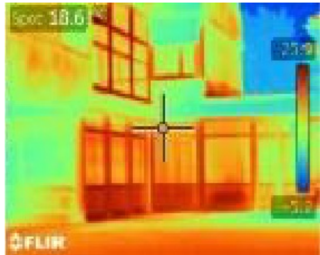
Thermographie de l'entrée du bâtiment depuis dehors (température extérieure 10 °C): des fuites de chaleur importantes
