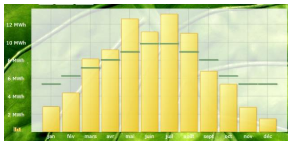
Installation photovoltaïque Coquerellaz : production mensuelle d'électricité (MWh) pour l'année 2022
