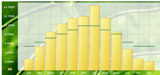
Installation photovoltaïque Coquerellaz : production mensuelle d'électricité (MWh) pour l'année 2019
