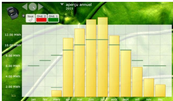
Production mensuelle d'énergie électrique (en MWh) par les panneaux solaires photovoltaïques de la Coquerellaz
